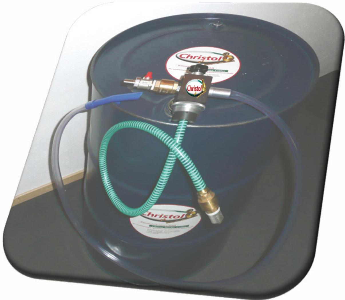
**Mischgerät zur Herstellung von stabilen Kühlschmieremulsionen von 1 - 15% Kühlschmierstoffanteil bei einer Leistung von bis zu 900 Liter/h bei einem Fließdruck bis 6 bar. Das Mischgerät lässt sich problemlos auf 25-Liter Kanistern aufstecken und mit dem Aluflansch auch auf 60-, bzw. 200-Liter Fässern.**
