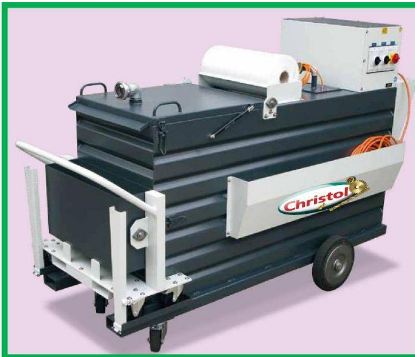
Der Schmutzbehälter, Inhalt = ca. 50 l, kann mit dem Stapler angehoben und mit einer Kippbewegung entleert werden. Das Vakuum wird über einen Seitenkanalverdichter erzeugt.
