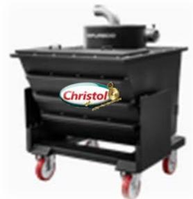
**ANTRIEB - DREHSCHIEBERPUMPE** Wir verwenden eine Drehschieberpumpe mit einem speziellen Absaugsystem.. Der maximale erreichbare Unterdruck ist 900mbars. In diesem besonderen Modell ist die Pumpe direkt mit dem elektrischen Motor verbunden. Das System ist mit einem Sicherheitsventil ausgestattet um sicheres kontinuierliches Betrieb zu gewährleisten.
