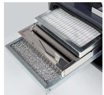
Die drei Filterstufen bestehen aus 1. Metallgestrickfilter (unten), Labyrinthfilter (Mitte) und Acrylfiltermatte (oben).
