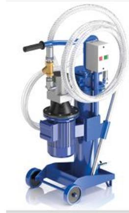
Der Filterwagen RCM 34 ist ein mobiles Filtrationssystem zum Befüllen, Spülen und Reinigen von Hydraulik- und Schmieröltanks. Er wird verwendet, um neues Öl vom Fass in den Öltank einer Anlage zu pumpen. Die Hydraulikflüssigkeit wird gleichzeitig gereinigt. Auch der Einsatz des Filterwagens zur Bypassfiltration ist möglich. Dazu wird der Filterwagen direkt an den Tank der hydraulischen Anlage angeschlossen. Zur dauerhaften Verwendung ist die Variante mit Drehstrommotor notwendig.
