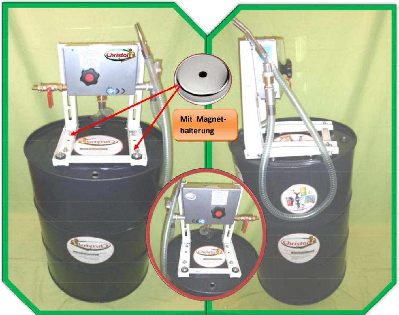
**VENTURI-Mischer** arbeiten nach dem Prinzip der Strahlpumpen. Die Energieübertragung an die Förderflüssigkeit (Kühlschmierstoff) erfolgt durch Mischen mit der Treibflüssigkeit (Wasser).
