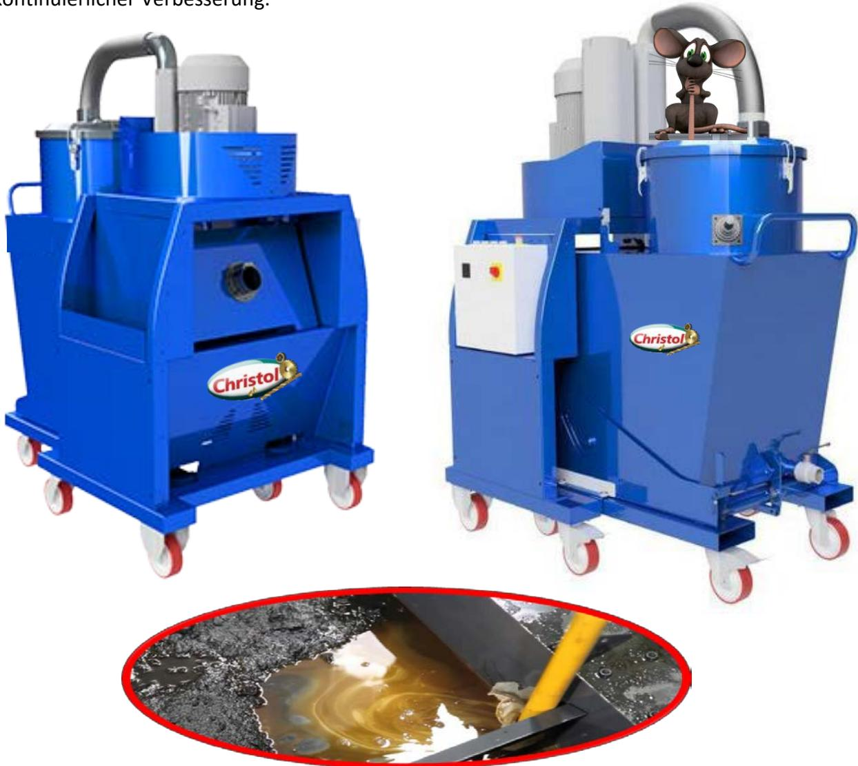
Die Vakuumeinheit kann mit zwei verschiedenen Turbinen (7,5 oder 12,5 kW) ausgestattet werden, die das Sammeln großer Mengen von Spänen in sehr kurzer Zeit ermöglichen. Das neue Design ermöglicht eine einfache Bewegung des Geräts zusammen mit seiner Turbine dank seiner Lenkräder oder per Gabelstapler. Vor dem Kippen des Schaufelvakuums kann die Turbine dank ihrer separaten Tragstruktur einfach abgenommen werden.
